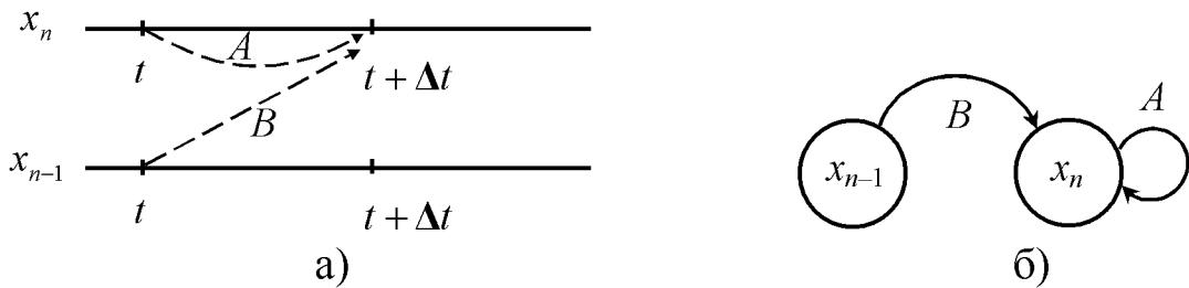
Рис. 3.4. Временная диаграмма (а) и участок диаграммы переходов (б) для состояния  $x_n$
