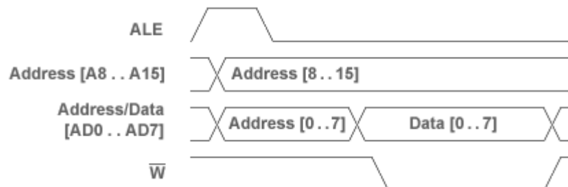
Рис. 16. Запись данных во внешнюю память AVR-микроконтроллера
