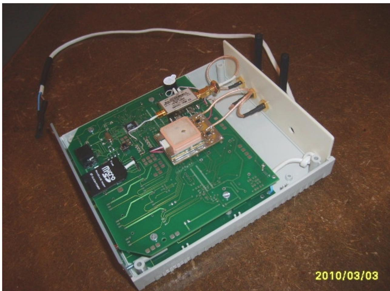
Рис. Внешний вид мобильного измерительного терминала
